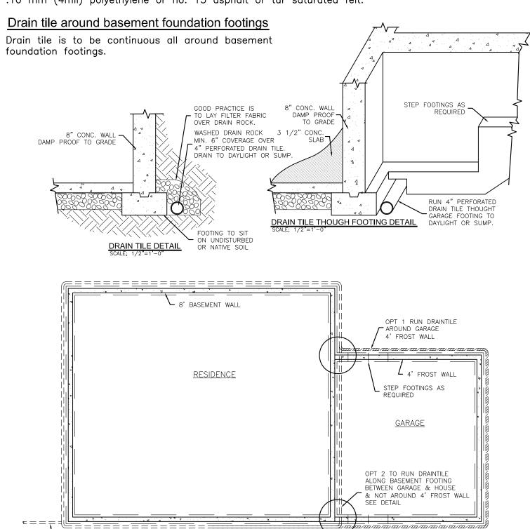
DRAIN TILE LAYING PLAN
